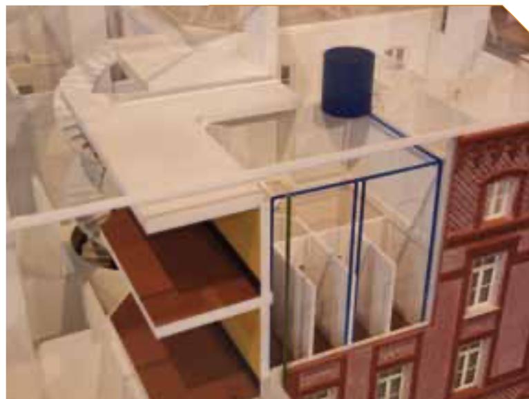
Le réservoir d'eau au-dessus des services sanitaires de l'escalier sud-est.
